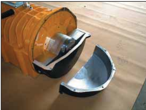
Calotte in 2 pezzi per una facile regolazione della forza centrifuga con spazio ristretto.
